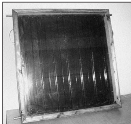
Рис. 2 Солнечный коллектор Ковровского механического завода с паяным вакуумным стеклопакетом. Предназначен для получения горячей воды за счет использования солнечной энергии. Производительность -100 л/сутки горячей воды с температурой 60÷90 °С. Снижение теплопотерь в коллекторе в 1,5...2 раза.
